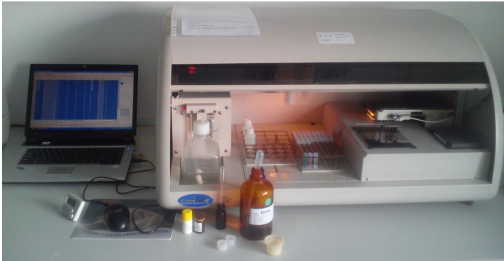
Slika 4. Automatizirani ELISA uređaj, kemijski analizator ChemWell 2910 , Awareness Technology Inc.
