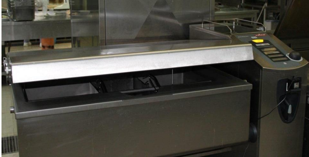
Slika 2. Uređaj za termičku obradu gotovih jela (Frima, Vario Cooking Center).
