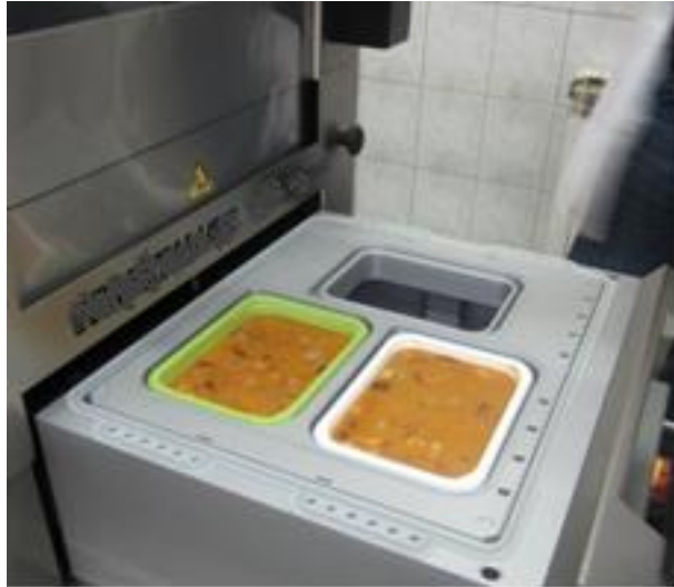
Slika 6. Prikaz uređaja za pakiranje u modificiranoj atmosferi (Multivac).
