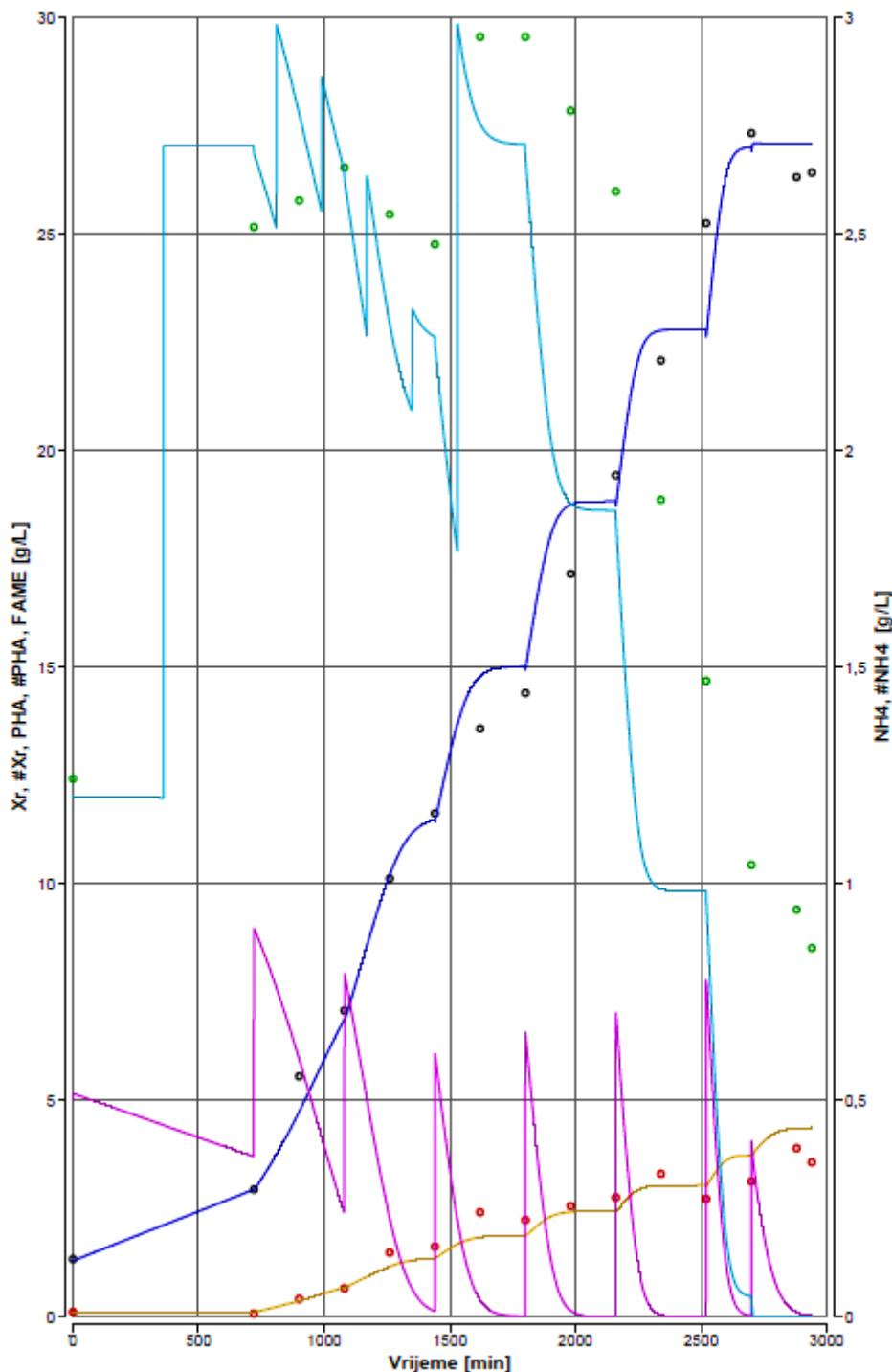
**Slika 5.** Rezultati simulacije biosinteze *mcl*-PHA u stanicama *P. chlororaphis* DSM 50083 (prvi uzgoj) i slaganje matematičkog modela s eksperimentalnim vrijednostima tijekom šaržnog uzgoja s pritokom supstrata.
