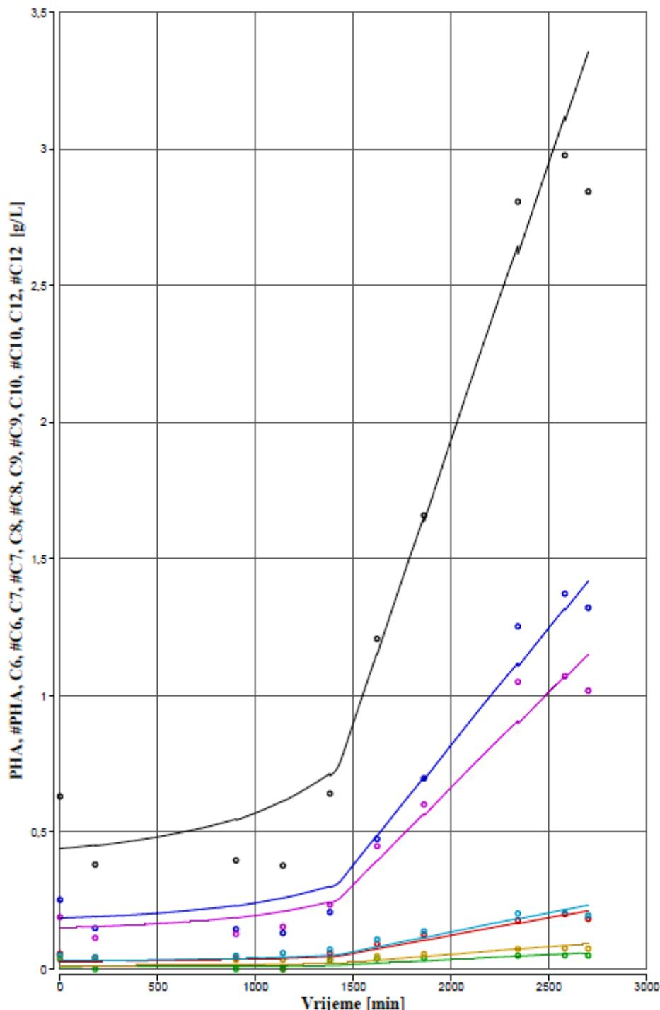
**Slika 14.** Prikaz rezultata simulacije (krivulje) i eksperimentalnih vrijednosti (kružići) koncentracije *mcl-PHA* i pripadnih monomera različitih duljina bočnih C-lanaca u uzgoju *P. citronellolis* DSM 50332 (drugi uzgoj).
