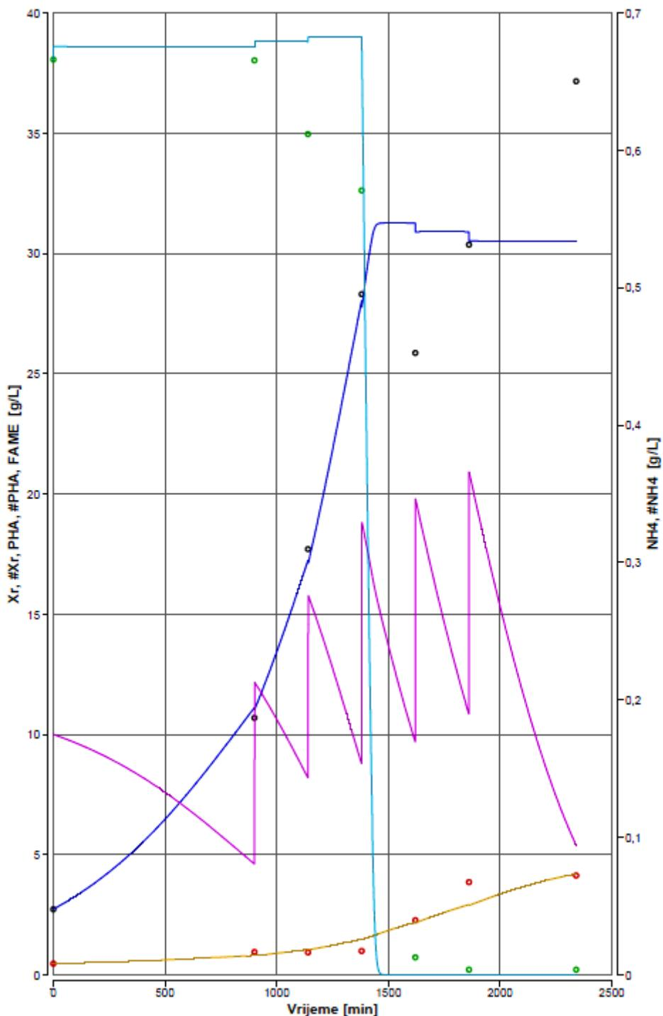
**Slika 7.** Rezultati simulacije biosinteze *mcl*-PHA u stanicama *P. chlororaphis* DSM 50083 (drugi uzgoj) i slaganje matematičkog modela s eksperimentalnim vrijednostima tijekom šaržnog uzgoja s pritokom supstrata.
