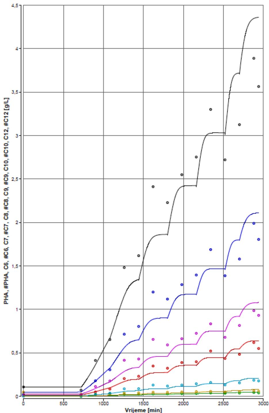
**Slika 6.** Prikaz rezultata simulacije (krivulje) i eksperimentalnih vrijednosti (kružići) koncentracije *mcl-PHA* i pripadnih monomera različitih duljina bočnih C-lanaca u uzgoju *P. chlororaphis* DSM 50083 (prvi uzgoj).
