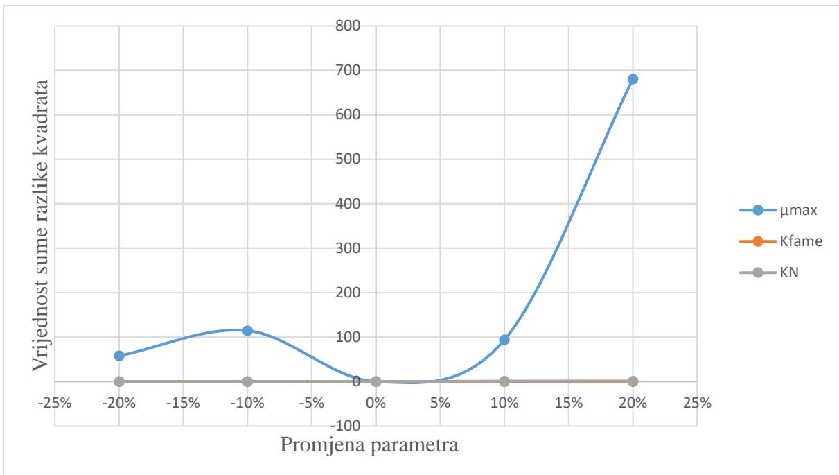
**Slika 17.** Rezultati testiranja osjetljivosti matematičkog modela biosinteze *mcl-PHA* u stanicama *P. chlororaphis* (treći uzgoja) na parametre  $\mu_{max}$ ,  $K_{fame}$  i  $K_N$  (referentni parametri:  $\mu_{max}=0,003407 \text{ min}^{-1}$ ,  $K_{fame}=0,1 \text{ g L}^{-1}$ ,  $K_N=0,05904 \text{ g L}^{-1}$ ).
