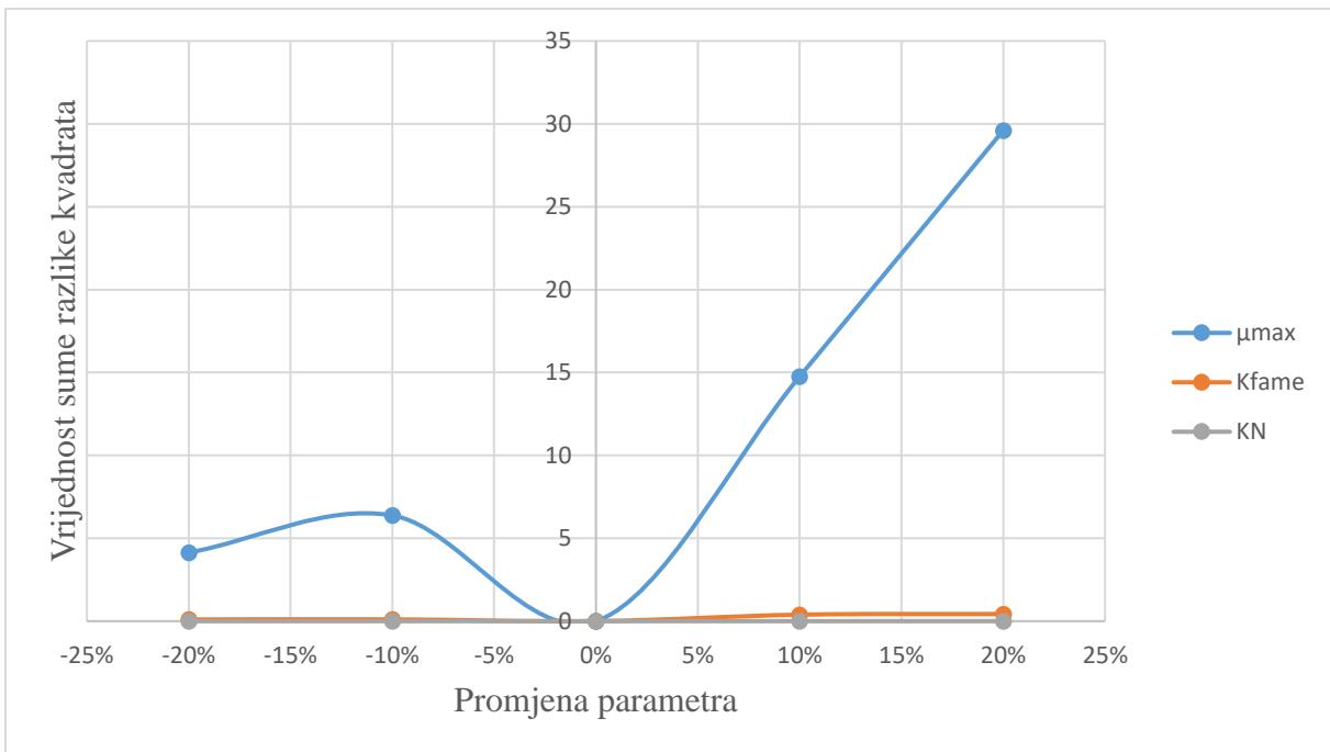
**Slika 15.** Rezultati testiranja osjetljivosti matematičkog modela biosinteze *mcl-PHA* u stanicama *P. chlororaphis* (prvi uzgoja) na parametre  $\mu_{max}$ ,  $K_{fame}$  i  $K_N$  (referentni parametri:  $\mu_{max}=0,00412 \text{ min}^{-1}$ ,  $K_{fame}=3,953 \text{ g L}^{-1}$ ,  $K_N=0,009 \text{ g L}^{-1}$ ).
