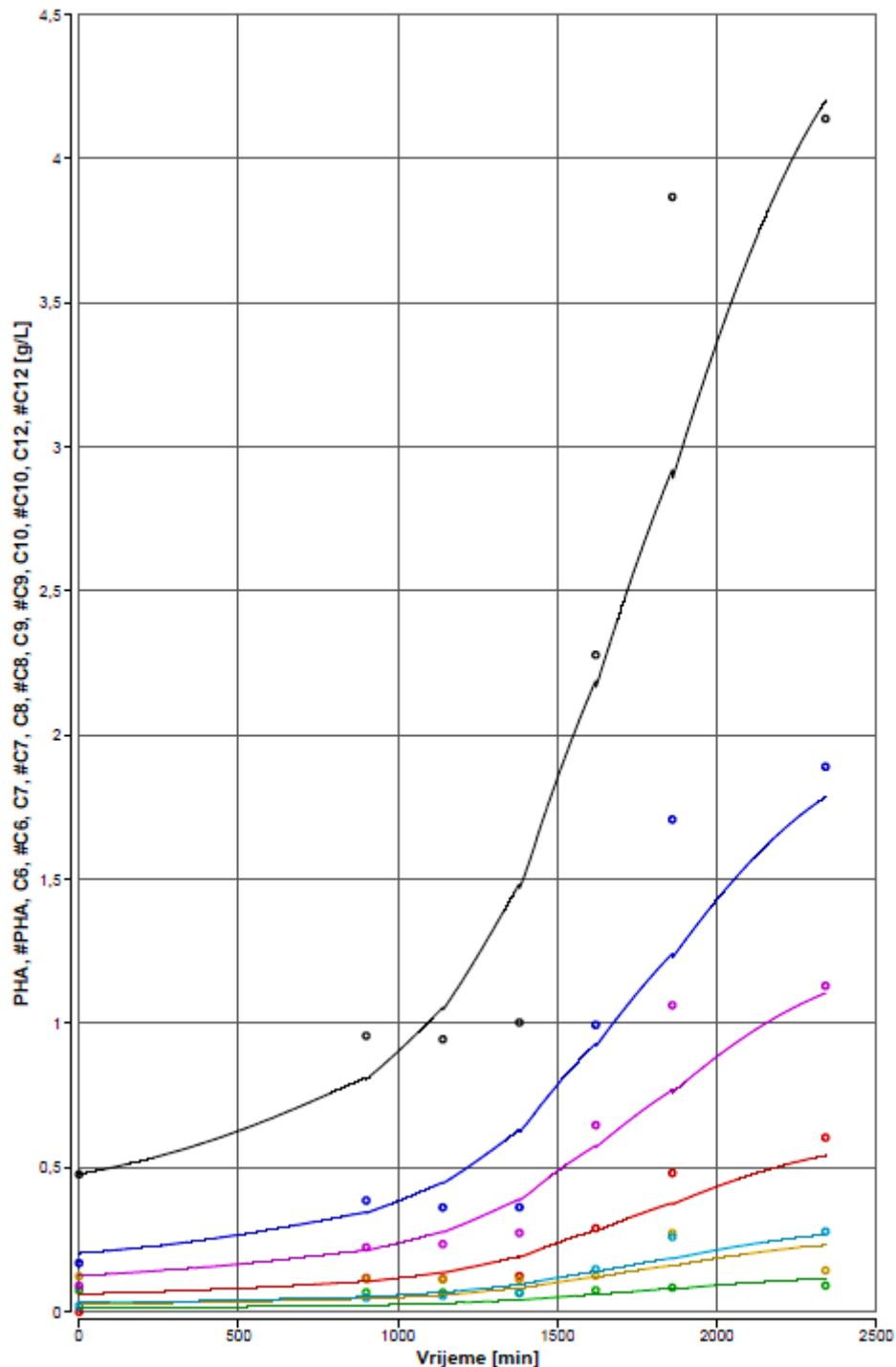
**Slika 8.** Prikaz rezultata simulacije (krivulje) i eksperimentalnih vrijednosti (kružići) koncentracije *mcl-PHA* i pripadnih monomera različitih duljina bočnih C-lanaca u uzgoju *P. chlororaphis* DSM 50083 (drugi uzgoj).
