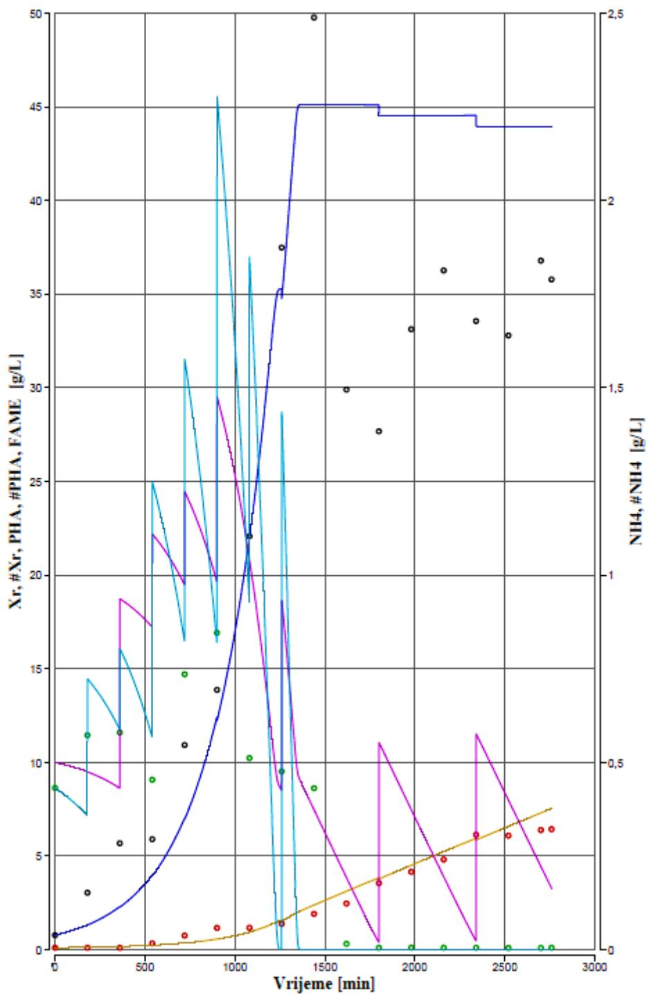
**Slika 9.** Rezultati simulacije biosinteze *mcl*-PHA u stanicama *P. chlororaphis* DSM 50083 (treći uzgoj) i slaganje matematičkog modela s eksperimentalnim vrijednostima tijekom šaržnog uzgoja s pritokom supstrata.
