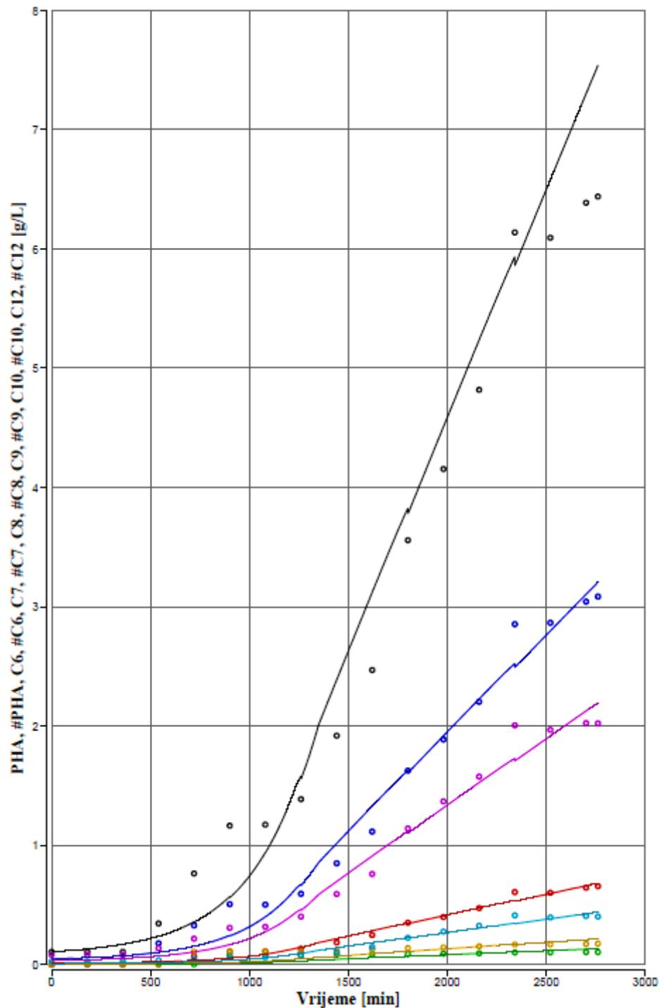
**Slika 10.** Prikaz rezultata simulacije (krivulje) i eksperimentalnih vrijednosti (kružići) koncentracije *mcl-PHA* i pripadnih monomera različitih duljina bočnih C-lanaca u uzgoju *P. chlororaphis* DSM 50083 (treći uzgoj).
