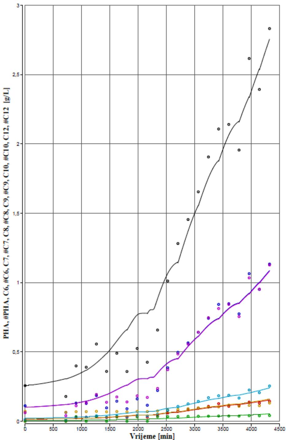
**Slika 12.** Prikaz rezultata simulacije (krivulje) i eksperimentalnih vrijednosti (kružići) koncentracije *mcl-PHA* i pripadnih monomera različitih duljina bočnih C-lanaca u uzgoju *P. citronellolis* DSM 50332 (prvi uzgoj).
