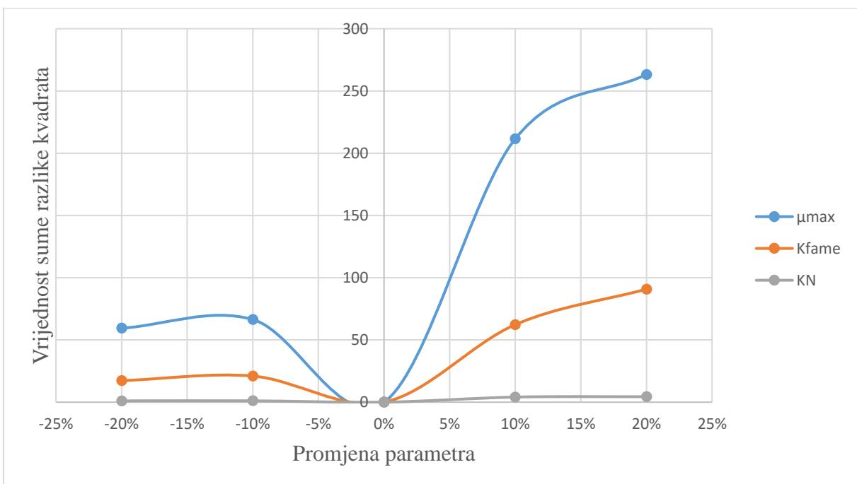
**Slika 16.** Rezultati testiranja osjetljivosti matematičkog modela biosinteze *mcl-PHA* u stanicama *P. chlororaphis* (drugi uzgoja) na parametre  $\mu_{max}$ ,  $K_{fame}$  i  $K_N$  (referentni parametri:  $\mu_{max}=0,005 \text{ min}^{-1}$ ,  $K_{fame}=13,6 \text{ g L}^{-1}$ ,  $K_N=0,1 \text{ g L}^{-1}$ ).
