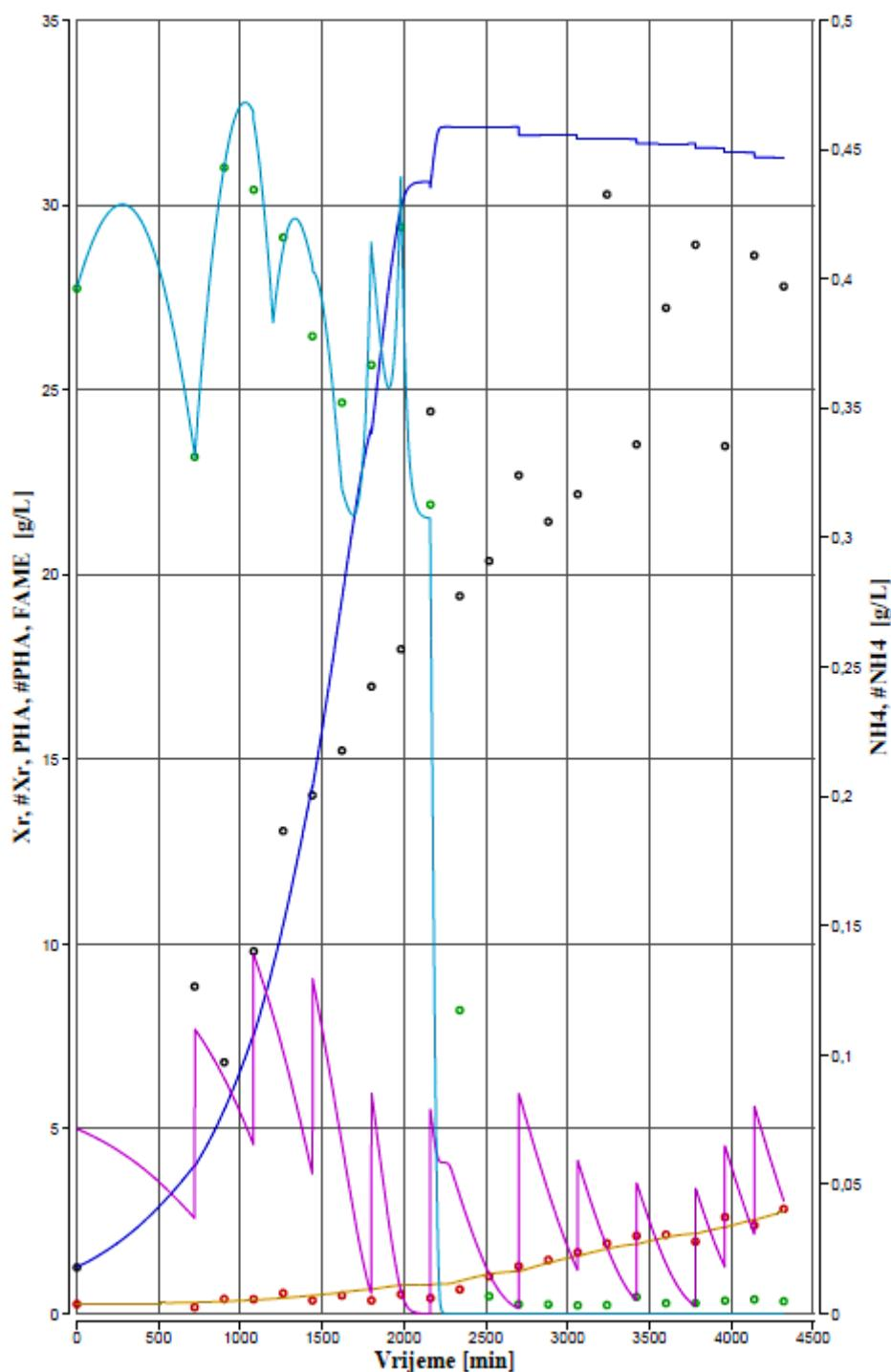
**Slika 11.** Rezultati simulacije biosinteze *mcl*-PHA u stanicama *P. citronellolis* DSM 50332 (prvi uzgoj) i slaganje matematičkog modela s eksperimentalnim vrijednostima tijekom šaržnog uzgoja s pritokom supstrata.
