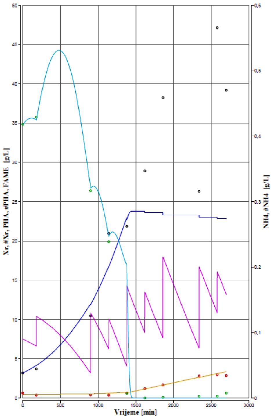
**Slika 13.** Rezultati simulacije biosinteze *mcl*-PHA u stanicama *P. citronellolis* DSM 50332 (drugi uzgoj) i slaganje matematičkog modela s eksperimentalnim vrijednostima tijekom šaržnog uzgoja s pritokom supstrata.
