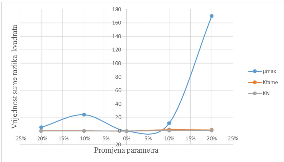
**Slika 18.** Rezultati testiranja osjetljivosti matematičkog modela biosinteze *mcl-PHA* u stanicama *P. citronellolis* (prvi uzgoja) na parametre  $\mu_{max}$ ,  $K_{fame}$  i  $K_N$  (referentni parametri:  $\mu_{max}=0,0037 \text{ min}^{-1}$ ,  $K_{fame}=1,18 \text{ g L}^{-1}$ ,  $K_N=0,05904 \text{ g L}^{-1}$ ).
