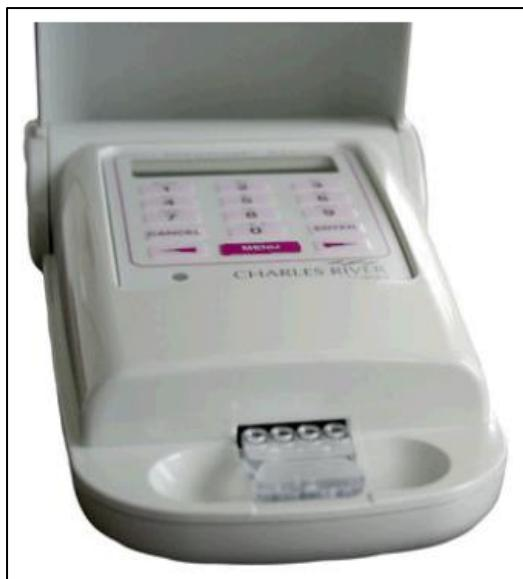
Slika 8. Prijenosni spektrofotometar
