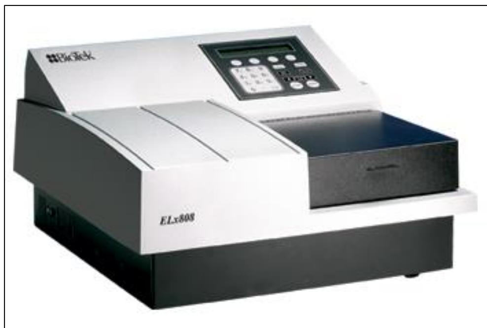
**Slika 6. Spektrofotometar za mikrotitarske pločice (BioTek, 2017)**
