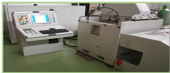
**Slika 12\***. Uredaj za visoki hidrostatski tlak (Stansted Fluid Power, Velika Britanija).
