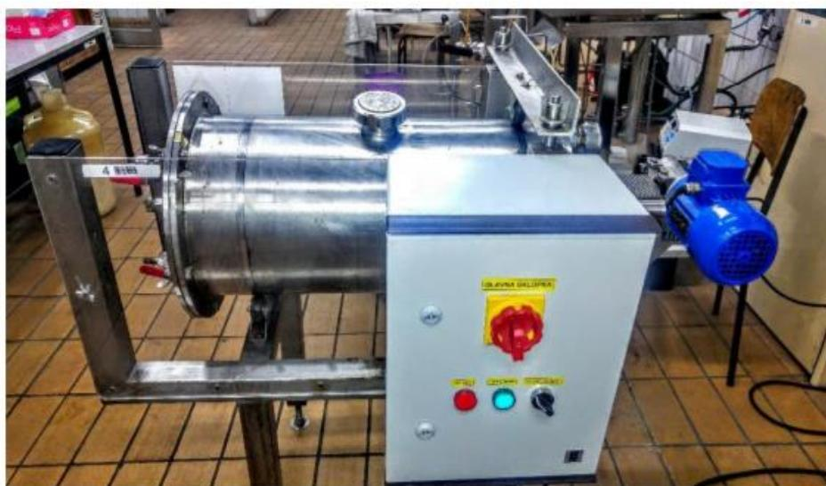
**Slika 8.** Horizontalni rotirajući cijevni bioreaktor (Rosing d.o.o., Hrvatska).
