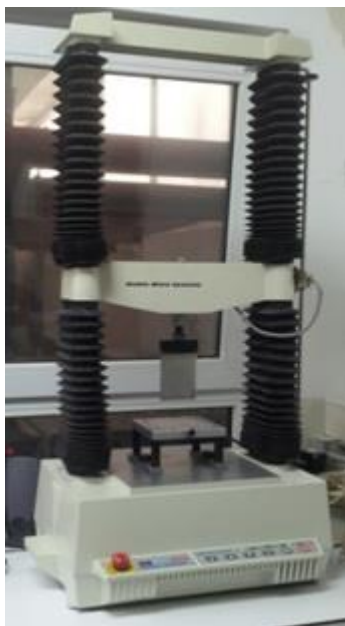
Slika 4. Uređaj korišten za instrumentalno određivanje teksture mesa (vlastita fotografija)
