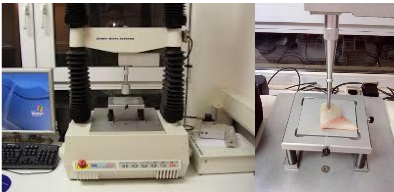
Slika 10. Stable Micro Systems TA-HD plus texture Analyser, nastavak 30 kg i promjer sonde 6 mm
