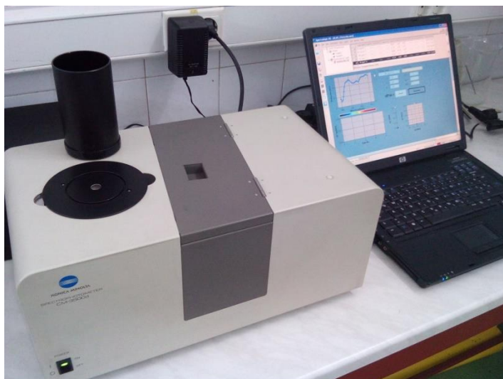
Slika 9. Konica Minolta spektrofotometar CM-3500d sa pločom promjera otvora 8 mm
