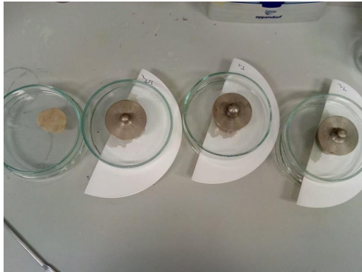
Slika 13. Metoda određivanja sposobnosti vezanja vode kod usitnjenog uzorka ribe pod opterećenjem
