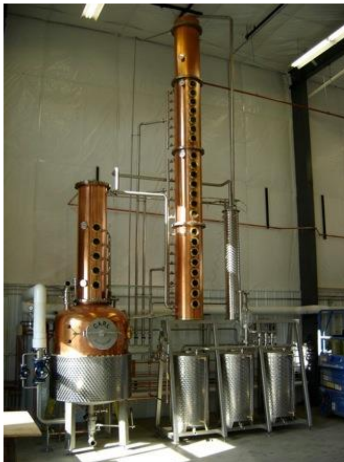
Slika 20. Kontinuirana destilacija u kolonama
