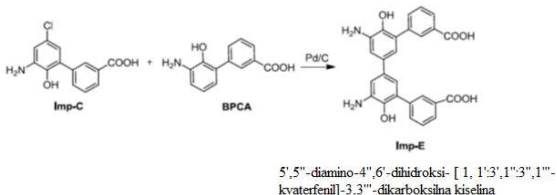
Shema 7. Onečišćenje E nastaje u reakciji BPCA i intermedijera C, katalizirano paladijem (Avdagic i sur., 2013).
