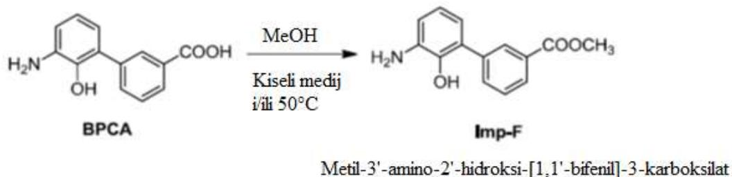
Shema 8. Onečišćenje F nastaje hidriranjem u metanolu, u kiselim uvjetima i pri visokoj temperaturi ( $50^{\circ}\text{C}$ ), (Avdagic i sur., 2013).
