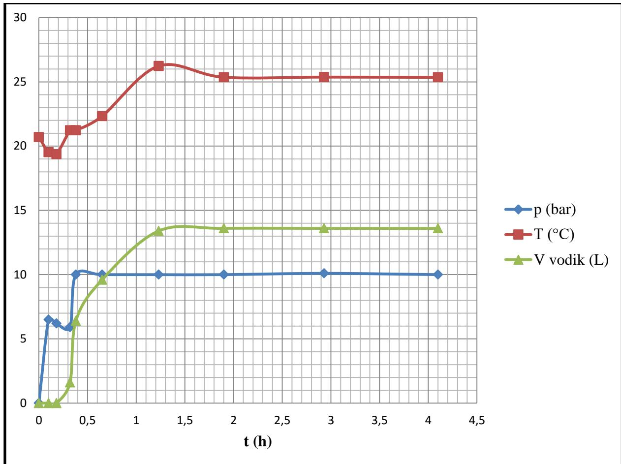
Slika 6. Grafički prikaz procesnih parametara ( $T/ ^\circ C$ ,  $V(H_2)/ L$  i  $p/ bar$ ) sinteze uzorka ELTC-1607 u ovisnosti o vremenu (t/h).
