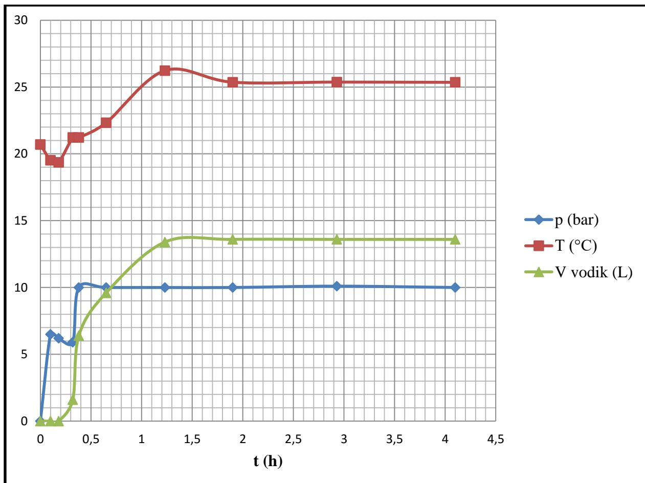
Slika 7. Grafički prikaz procesnih parametara ( $T/ ^\circ C$ ,  $V(H_2)/ L$  i  $p/ bar$ ) sinteze uzorka ELTC-1609 u ovisnosti o vremenu (t/h).
