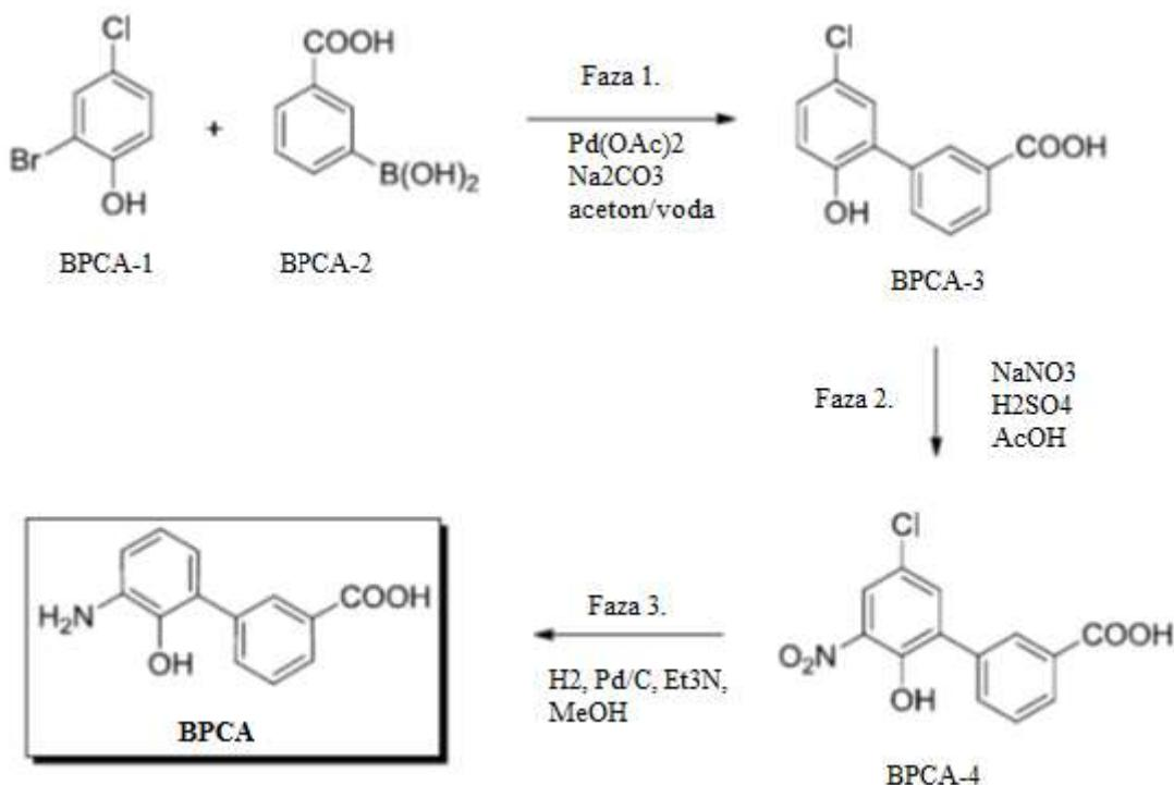
Shema 2. Sinteza 3'-amino-2'-hidroksi-[1,1'-bifenil]-3-karbokisilne kiseline (BPCA)
