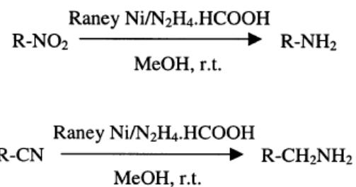
Shema 10: R=alkil i aril ostatak supstituiran sa -OH, OR, -CO<sub>2</sub>H, -CO<sub>2</sub>R, -CONH<sub>2</sub>, -NHCOCH<sub>3</sub>; alifatski i aromatski nitro spojevi i nitrili mogu se reducirati u odgovarajuće amino derivate koristeći Raney nikal i hidrazinij monoformijat kao katalizator (Gowda i sur., 2002).
