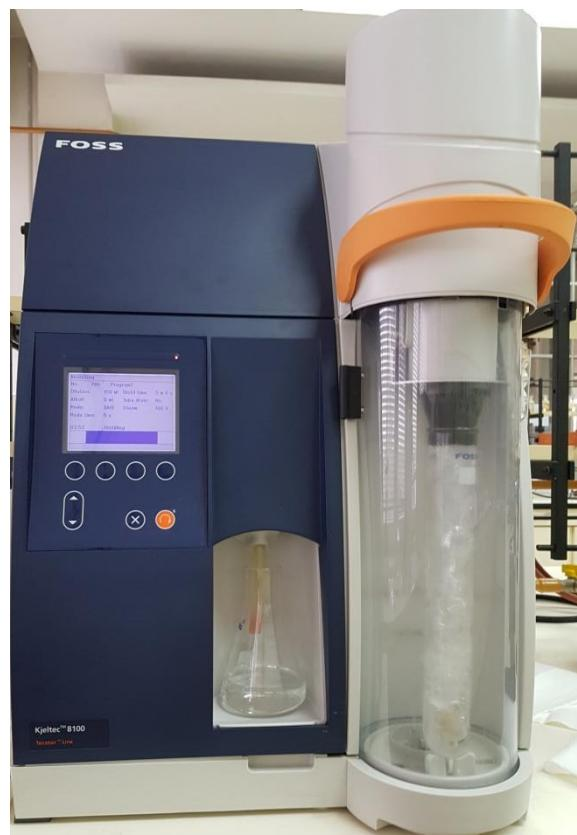
Slika 10. Foss Kjeltec 8100 sustav za destilaciju (vlastita fotografija)
