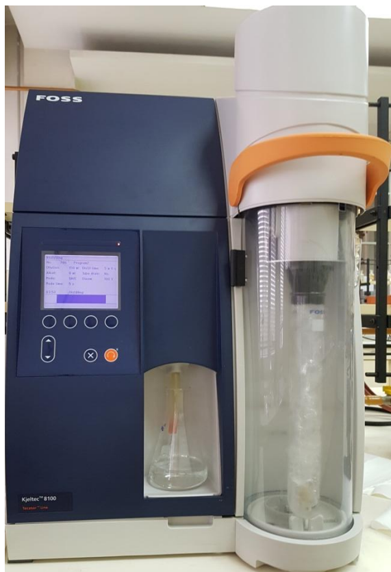
Slika 10. Foss Kjelttec 8100 sustav za destilaciju (vlastita fotografija)
