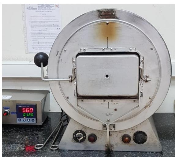
Slika 7. Mufolna peć (vlastita fotografija)
