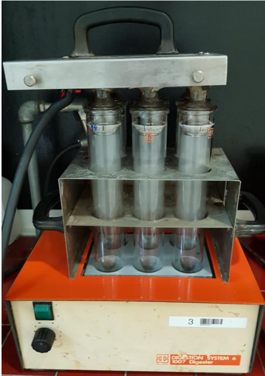
Slika 9. Blok za spaljivanje uzoraka po Kjeldahl-ovom postupku (vlastita fotografija)
