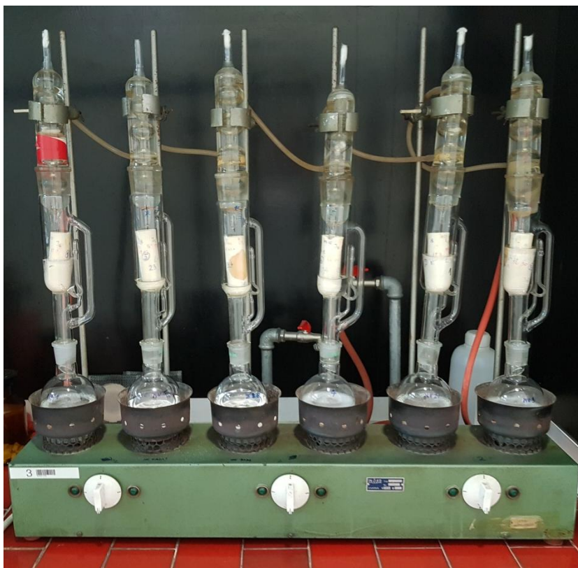
Slika 8. Aparatura po Soxhletu (vlastita fotografija)
