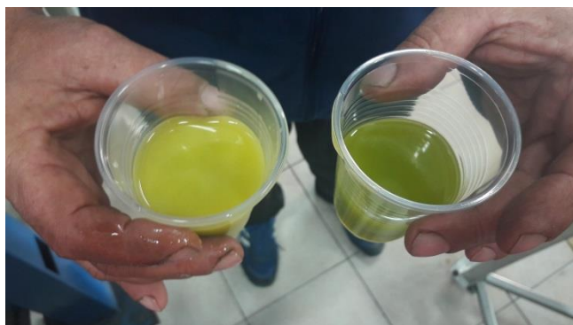
Slika 7. Filtracija – lijevo nefiltrirano ulje (uljni mošt), desno filtrirano ulje (vlastita fotografija)
