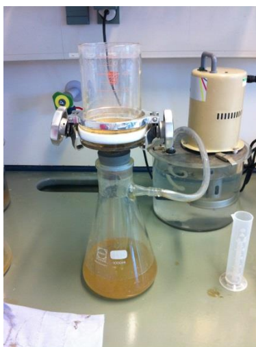
Slika 10. Filtriranje uzorka otpadne vode pomoću vakuum filtera (lijevo)
