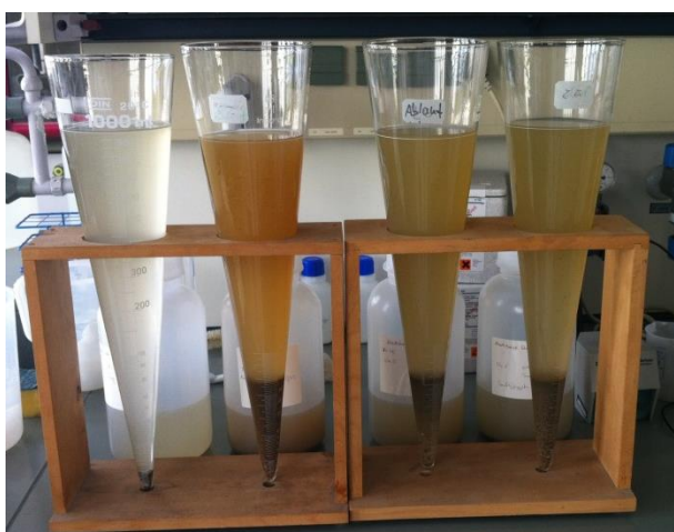
Slika 19. Prikaz taloženja suspendiranih čestica u 1L uzorka otpadne vode u Imhoff-ovom lijevku nakon 10 minuta, 30 minuta i 2 sata (uzorci 3, 4, 5, 6)
