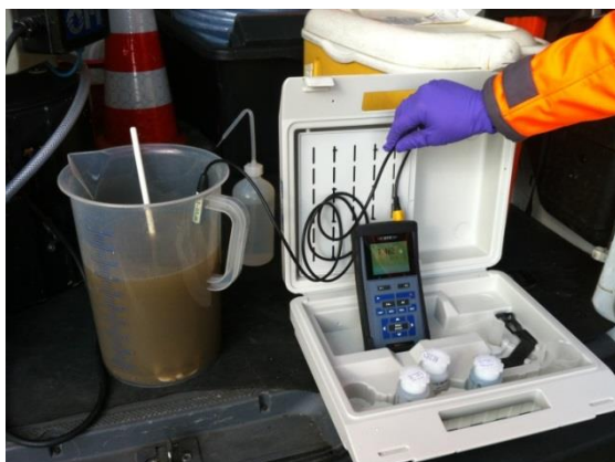
Slika 9. Određivanje pH vrijednosti i temperature uzorka
