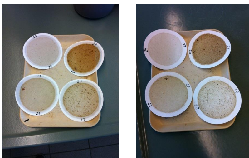
Slika 17. Filterpapir sa suspendiranim tvarima (uzorci 3, 4, 5, 6) prije sušenja (lijevo) i nakon sušenja (desno)
