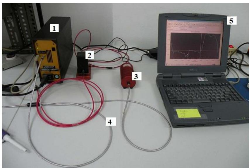
**Slika 12.** NIR instrument povezan s računalom s označenim dijelovima: 1) NIR instrument; 2) mjesto za snimanje uzorka u kiveti; 3) izvor svjetlosti; 4) optički kablovi; 5) računalo
