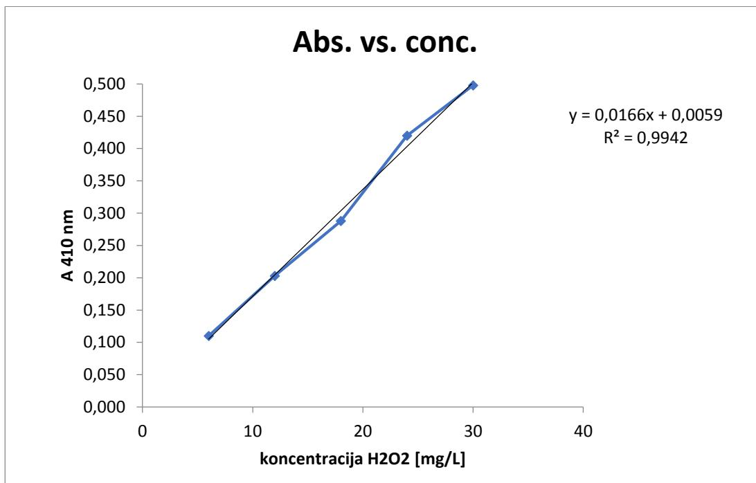
**Slika 11.** Baždarni dijagram ovisnosti apsorbancije o koncentraciji H<sub>2</sub>O<sub>2</sub>
