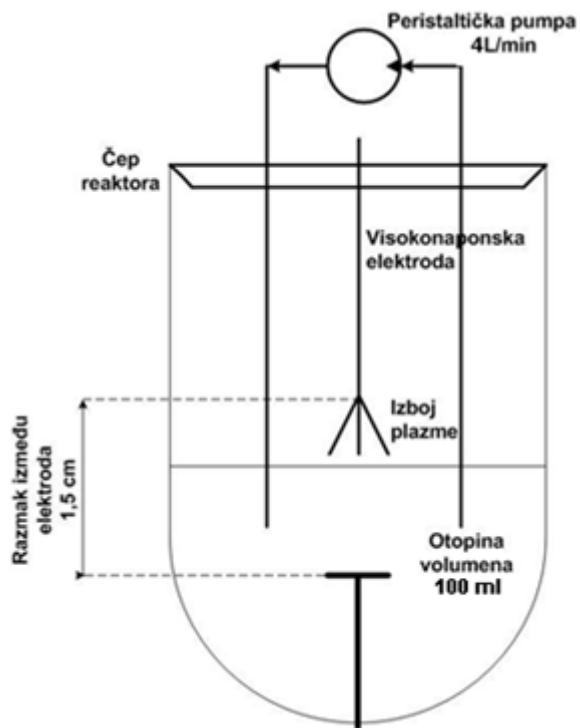
**Slika 10.** Shema reaktora s plinskom plazmom
