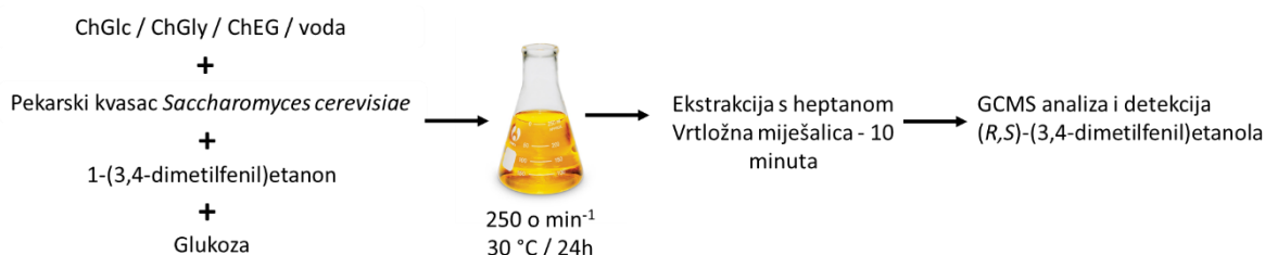
Slika 8. Pojednostavljena shema redukcije 1-(3,4-dimetilfenil)etanona i detekcije produkta
