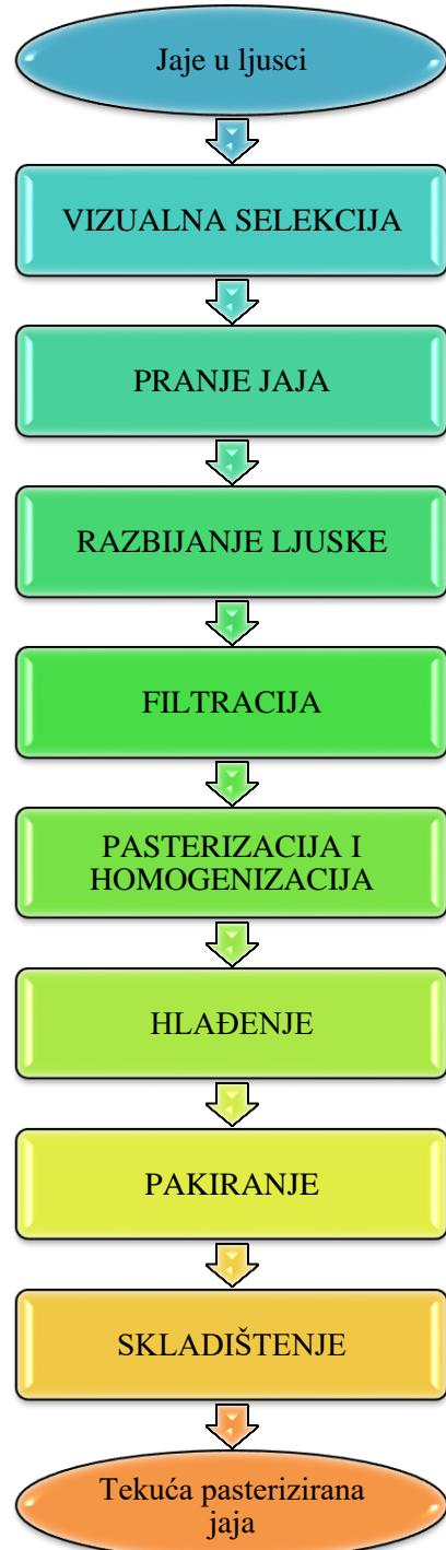
**Slika 4.** Blok shema proizvodnje tekućih jaja (EEPA, 2011)
