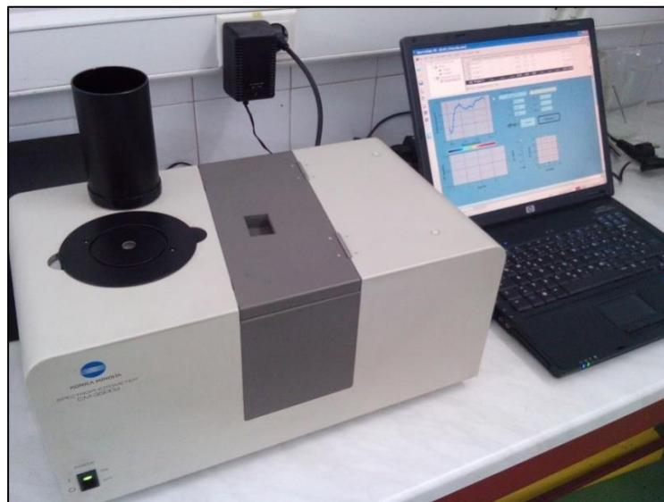
**Slika 6.** Konica Minolta spektrofotometar CM-3500d (vlastita fotografija)
