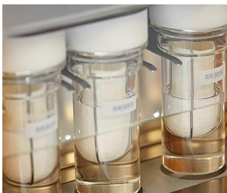
Slika 26. Aparatura za ekstrakciju masti po Soxhletu (sustav Soxterm, Gerhardt)
