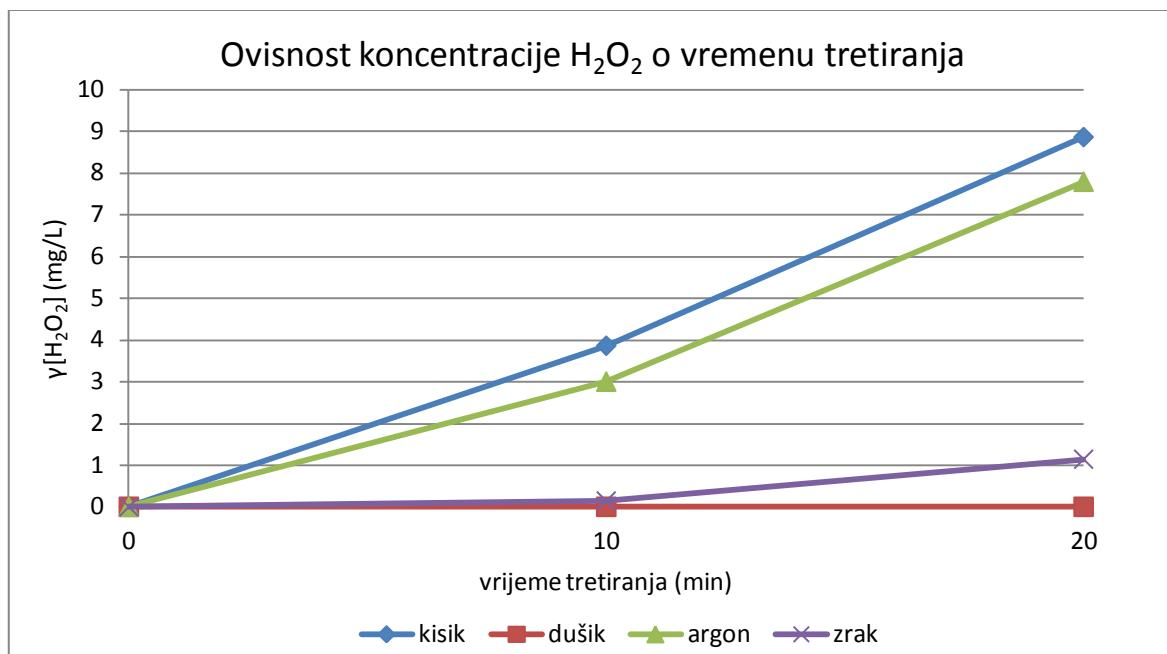
Slika 11. Ovisnost koncentracije  $\text{H}_2\text{O}_2$  o vremenu tretiranja tijekom tretmana plinskom plazmom s radnim plinovima ( $\text{O}_2$ ,  $\text{N}_2$ , Ar i zrak) pri frekvenciji od 120 Hz
