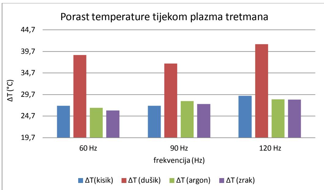
Slika 8. Porast temperature tijekom plazma tretmana s radnim plinovima ( $\text{O}_2$ ,  $\text{N}_2$ , Ar, zrak)
