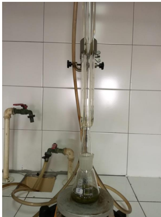
Slika 10. Ekstrakcija refluksiranjem pri temperaturi ključanja otapala
