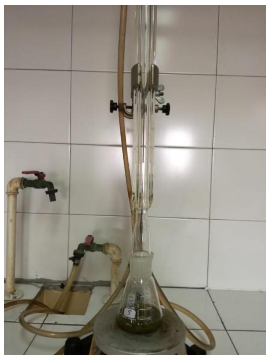
**Slika 10.** Ekstrakcija refluksiranjem pri temperaturi ključanja otapala
