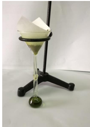
Slika 12. Filtracija preko lijevka i filter papira
