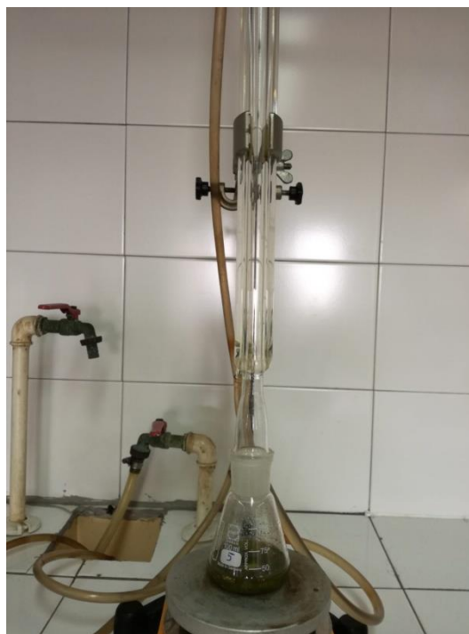
Slika 10. Ekstrakcija refluksiranjem pri temperaturi ključanja otapala
