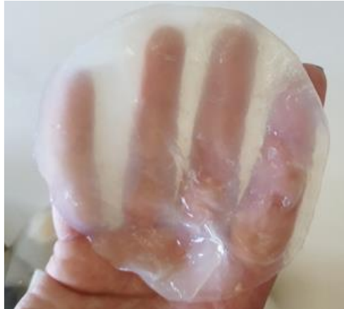
Slika 11. Sintetizirana celulozna pelikula kombuche u kokosovoj vodi nakon 24 sata fermentacije
