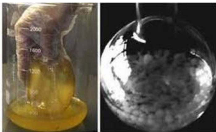
Slika 3. Izgled sintetizirane BNC uzgojene u statičkoj i miješanoj kulturi (Chawla i sur., 2009)
