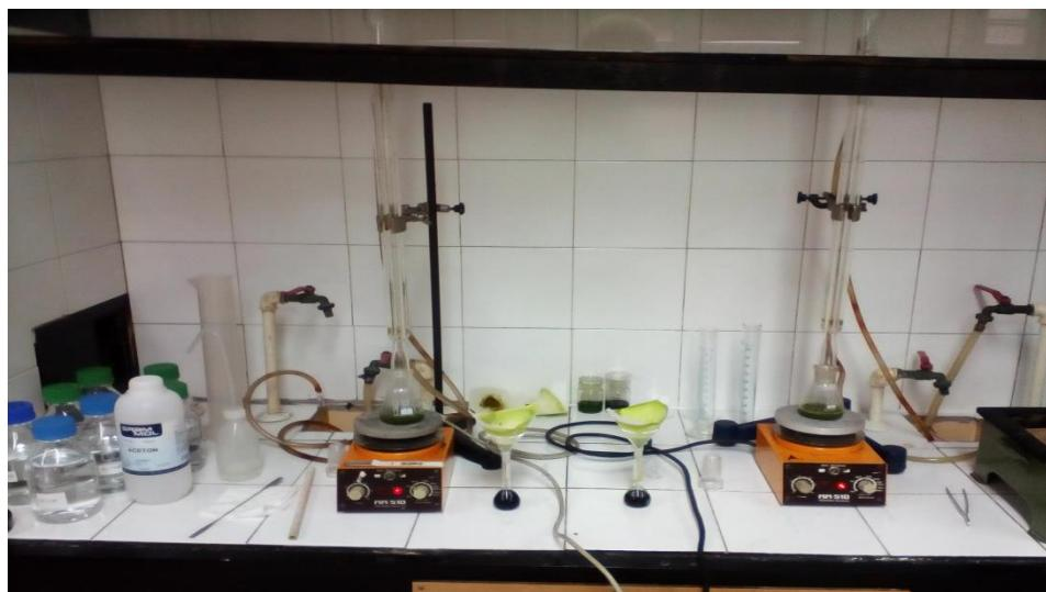
Slika 6. Ekstrakcija refluksiranjem (vlastita fotografija)
