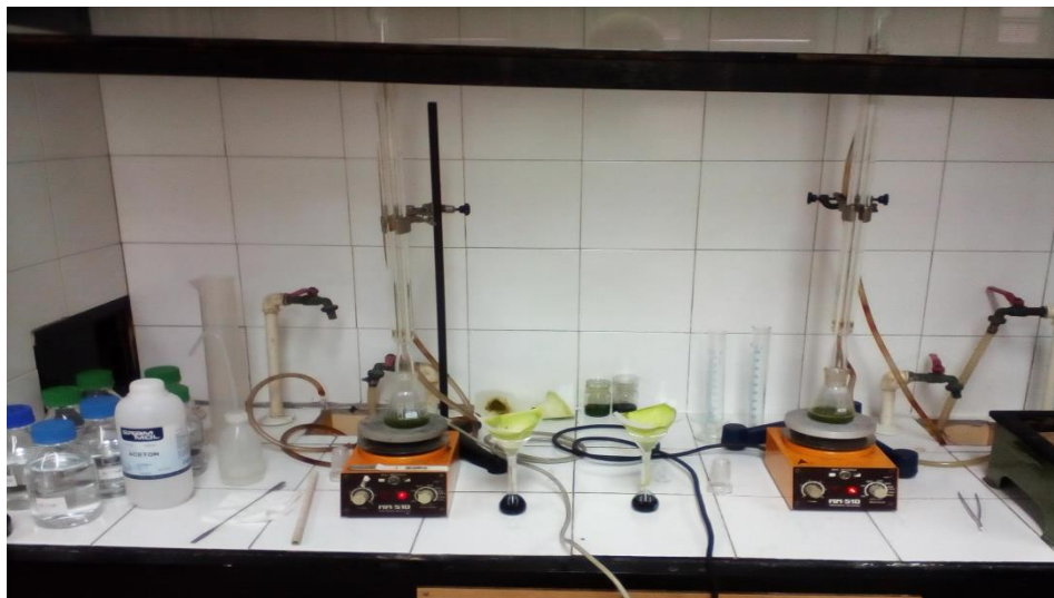
Slika 6. Ekstrakcija refluksiranjem (vlastita fotografija)
