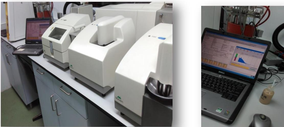
Slika 10. Uredaj za LD analizu Mastersizer 2000, Malvern Instruments, UK: optički instrument i mjerne ćelije Scirocco, HydroS i HydroμP
