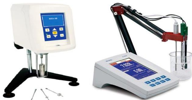
Slika 6. digitalni viskozimetar i digitalni pH-metar
