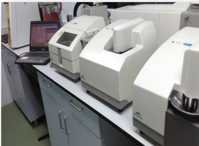
Slika 10. Uređaj za LD analizu Mastersizer 2000, Malvern Instruments, UK: optički instrument i mjerne ćelije Scirocco, HydroS i Hydro \mu P
