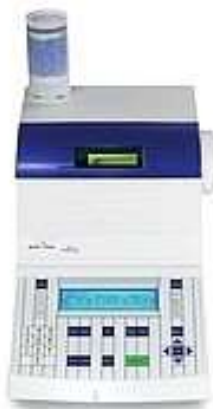
Slika 10. Uređaj za mjerenje gustoće „Mettler Toledo Density Meter DE 40“ (MT, 2018)
