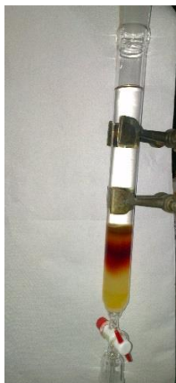
Slika 10. Kromatografska kolona na stupcu od silika gela pri pročišćavanju N1-ferocenoil uracila
