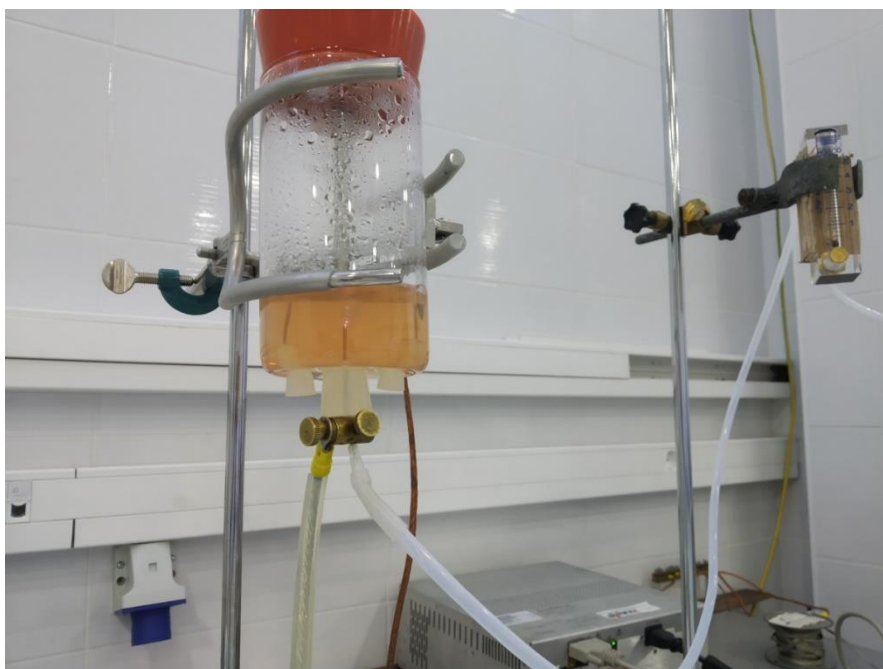
Slika 4. Prikaz hibridnog reaktora HVED plazme (vlastita fotografija)
