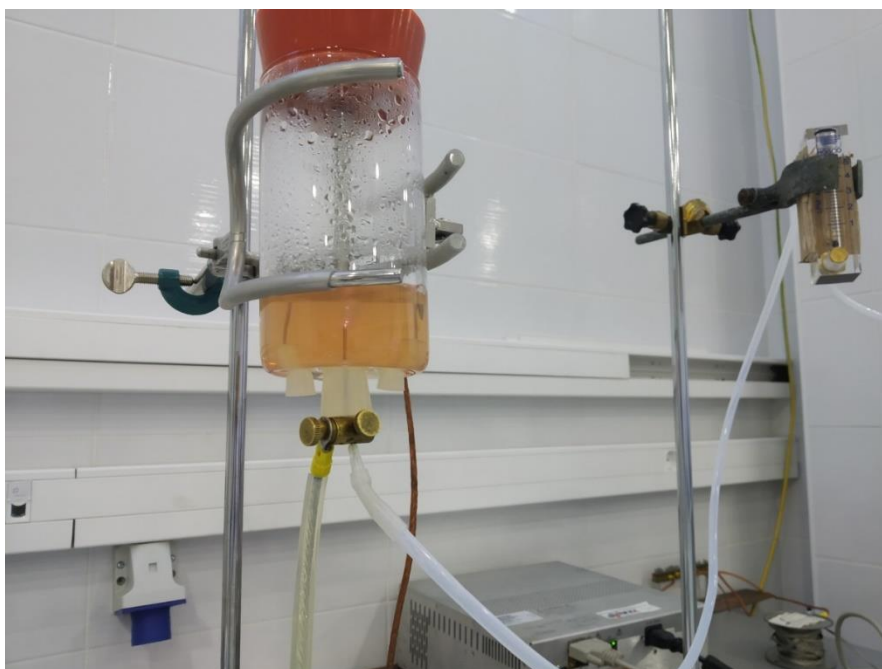
Slika 4. Prikaz hibridnog reaktora HVED plazme (vlastita fotografija)
