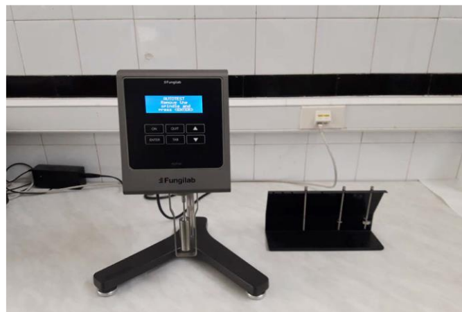
Slika 2. Digitalni viskozimetar Fungilab ALPHA.
