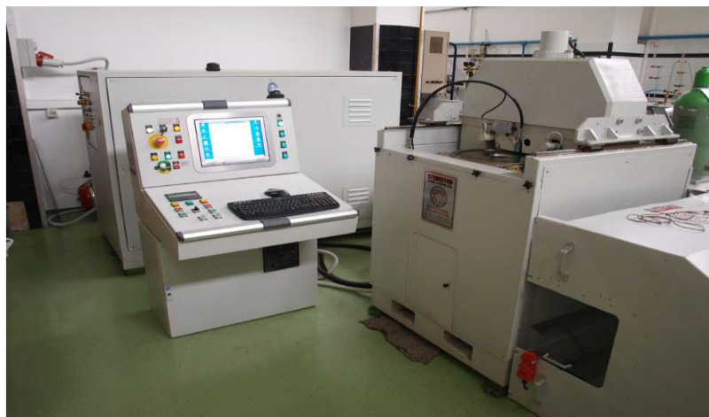
Slika 5. Uređaju za obradu namirnica visokim hidrostatskim tlakom Stansted Fluid Power
