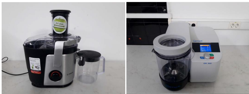
Slika 4. Sokovnik BOSCH MES 4000 i mlin s noževima RETSCH GM 300
