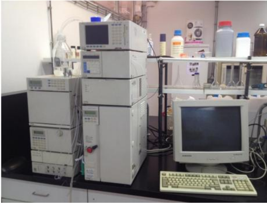
Slika 13. HPLC- uređaj za tekućinsku kromatografiju visoke učinkovitosti.
