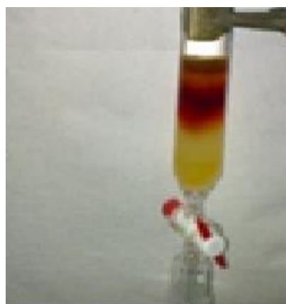
Slika 14. Kromatografska kolona na stupcu od silika gela pri pročišćavanju N1-ferocenoil uracilnih derivata
