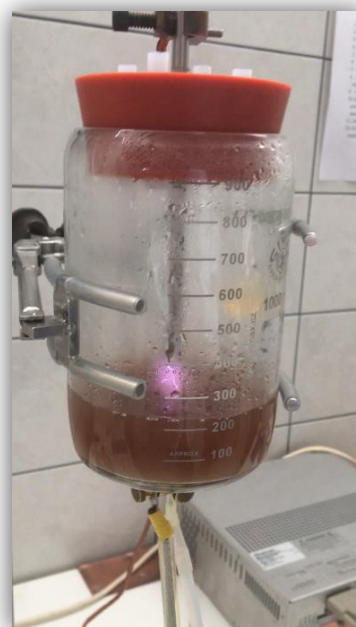
Slika 8. Tretman otpadne vode hladnom plazmom (vlastita fotografija)
