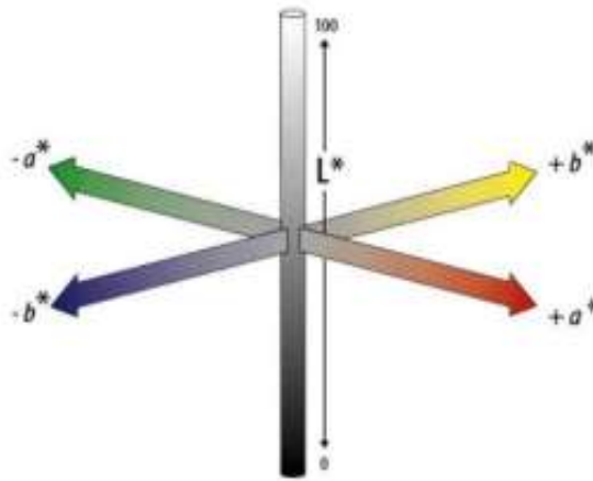
Slika 8. Određivanje boje u L*a*b* sustavu (Konica-Minolta, 1998)
