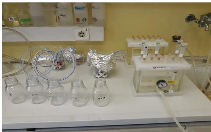
Slika 8. Aparatura za ekstrakciju na čvrstoj fazi ( SPE )
