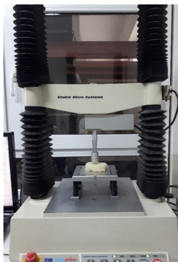
Slika 9. Teksturometar TA.HD plus Texture Analyser (Stable Micro Systems, UK) sa sondom promjera 25 mm (Vlastita fotografija)
