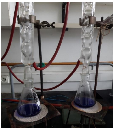
Slika 10. Zagrijavanje tikvica povezanih s povratnim hladilom (Vlastita fotografija)
