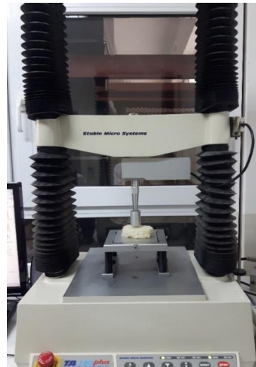
Slika 9. Teksturometar TA.HD plus Texture Analyser (Stable Micro Systems, UK) sa sondom promjera 25 mm (Vlastita fotografija)
