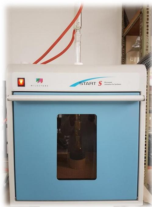
**Slika 7.** Uredaj za mikrovalnu ekstrakciju, mikrovalni reaktor (MILESTONE, START S Microwave Labstation for Synthesis) (vlastita fotografija)
