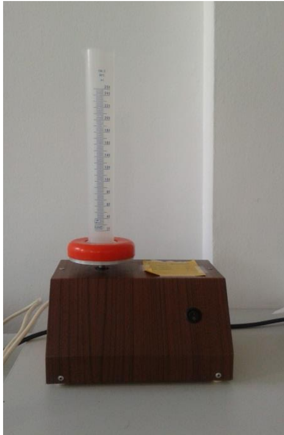
Slika 2. Uređaj za određivanje vibracijske nasipne gustoće (Vlastita fotografija)
