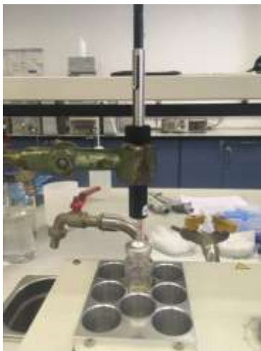
Slika 9. HS-SPME ekstrakcija (vlastita fotografija)
