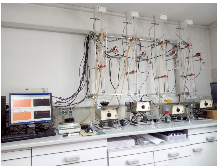
Slika 2. Postavljena aparatura za automatsku destilaciju (Osobna fotografija)
