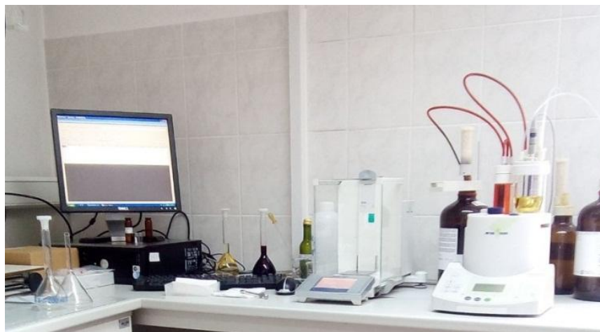
Slika 3. Aparatura za Karl-Fischer titraciju (osebna fotografija)
