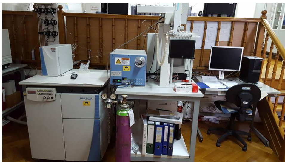
Slika 5. Fotografija radne jedinice sa spojenim IRMS Delta V Plus instrumentom (osobna fotografija)
