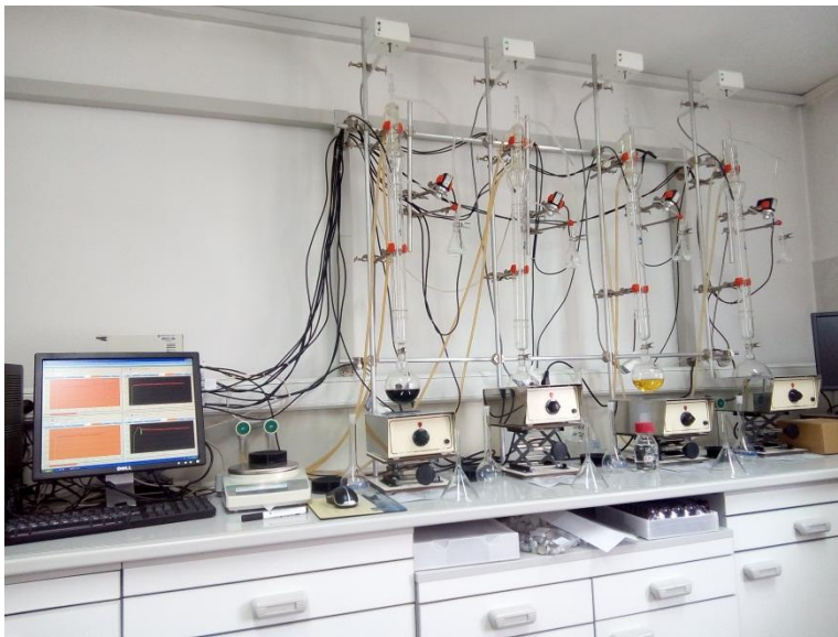
Slika 2. Postavljena aparatura za automatsku destilaciju (Osobna fotografija)
