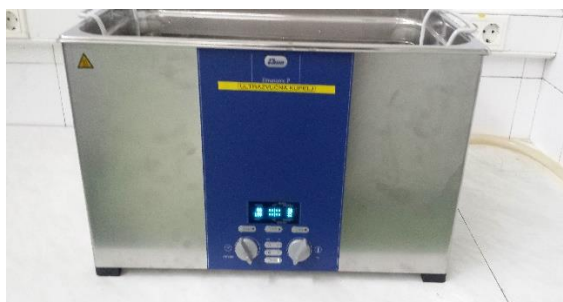
Slika 3. Ultrazvučna kupelj Elmasonic P 300 H (Elma, Singen, Njemačka).
