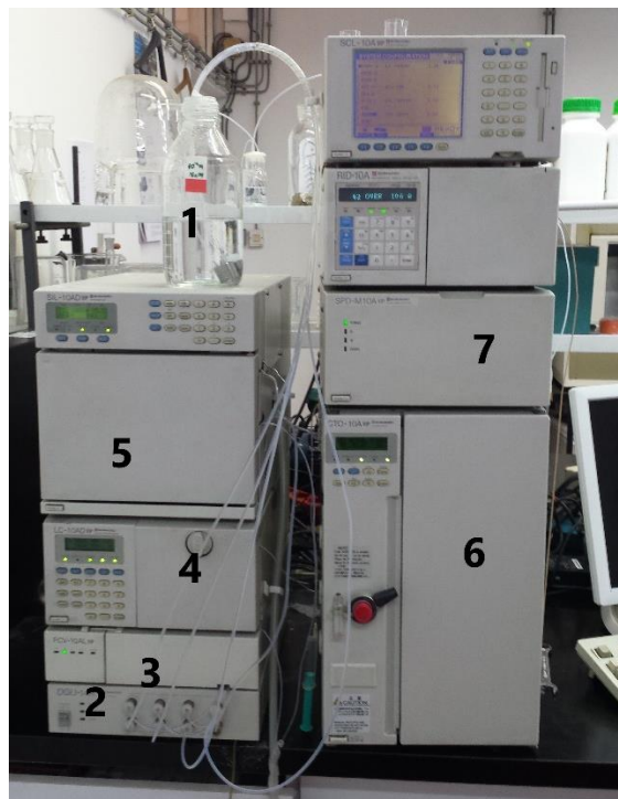
Slika 4. Kromatograf Shimadzu CLASS-VP LC-10A VP (Shimadzu; Kyoto, Japan). 1- boca za mobilnu fazu; 2 - otplinjač; 3 - podjedinica za formiranje gradijenta; 4 - pumpa; 5 auto-injektor; 6 - pećnica s predkolonom i kolonom; 7- detektor.
