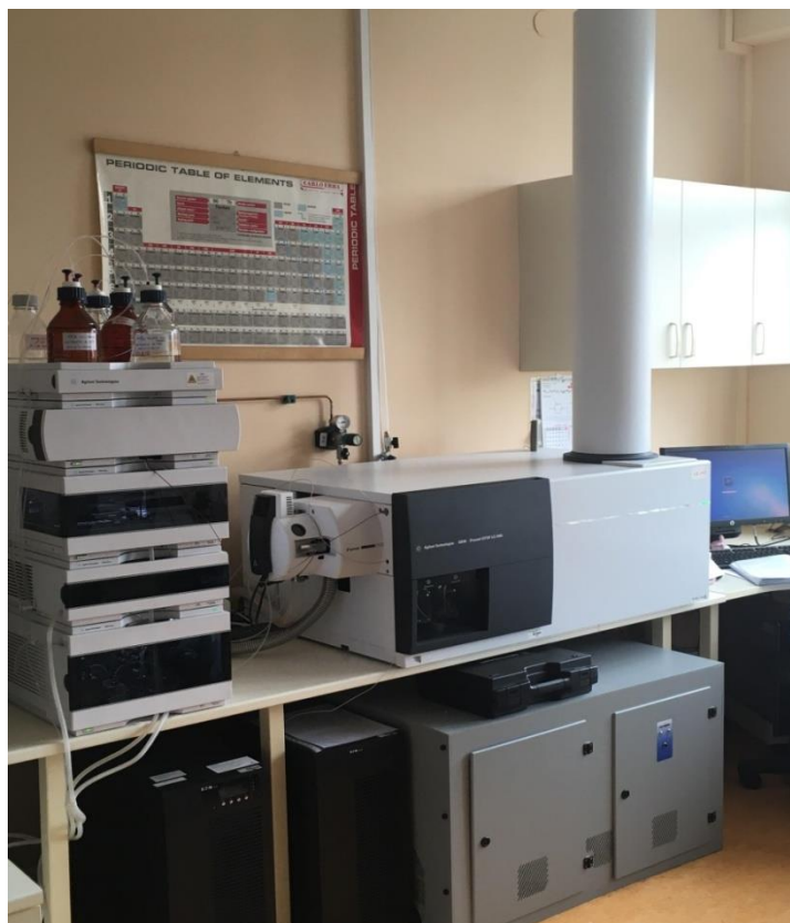
Slika 8. HPLC uređaj Agilent 1290 Infinity udružen s analizatorom mase s vremenom preleta (Agilent UHPLC/Q-TOF-MS G6550) (vlastita fotografija)
