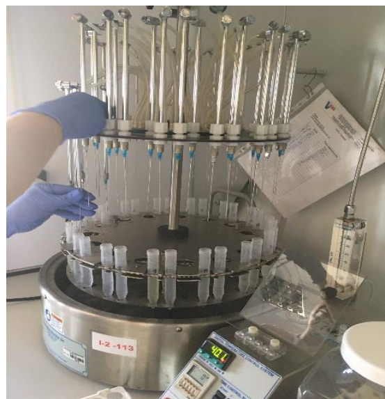
Slika 7. Postupak uparavanja uzoraka (vlastita fotografija)
