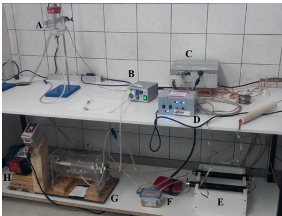
Slika 6. Sustav za generiranje plazme u tekućini visokonaponskim pražnjenjem: A) reaktor, B) pumpa, C) visokonaponski generator, D) kontrolna jedinica za napajanje, E) otpornici 9,5\text{ M}\Omega , F) kondenzator 0,75\text{ nF} , G) rotirajuća sklopka, H) elektromotor s regulatorom frekvencije (arhiva Laboratorija za procesno-prehrambeno inženjerstvo).
