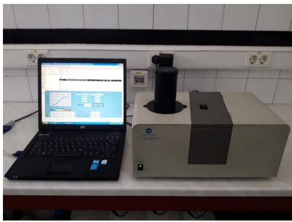
**Slika 3.** Konica Minolta Spectrophotometer CM-3500d. (Laboratorij za tehnološke operacije, 2008)
